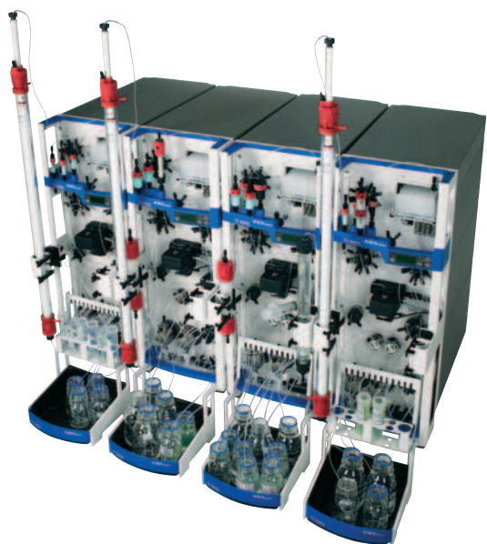
Fig 7. Four modules of ÄKTAexpress system.
